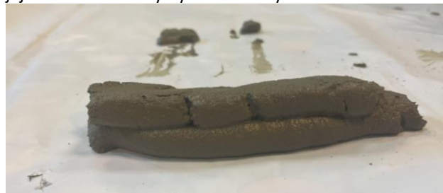
Rys. 6. Próba wyciskania pasma z zaprawy z zawartością pulpy papierowej
