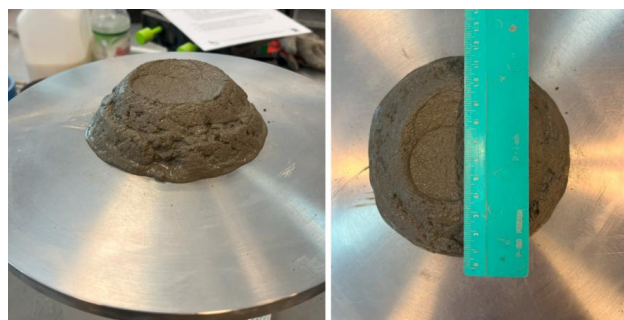
Rys. 3. Badanie konsystencji zaprawy
