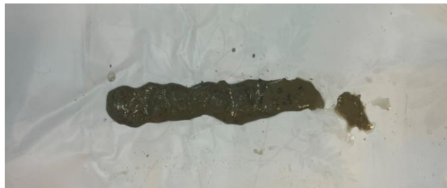
Rys. 6. Próba wyciskania pasma z zaprawy normowej
