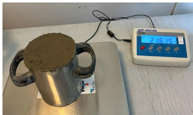
Rys. 2. Wążenie próbek w celu określenia gęstości świeżej zaprawy
