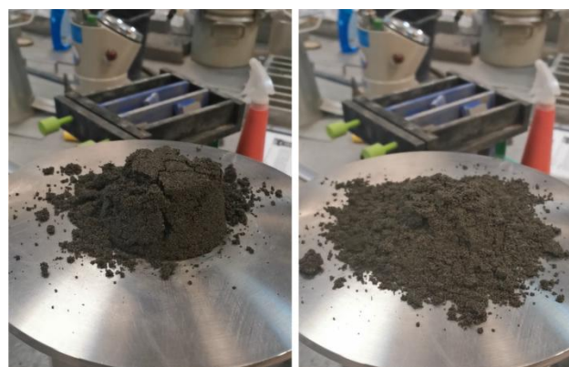
Rys. 3. Rozsypanie próbki z dodatkiem 20% gumy podczas badania konsystencji za pomocą stolika rozpląwu, ilustrujące brak możliwości wykonania oznaczenia z powodu braku spójności zaprawy
