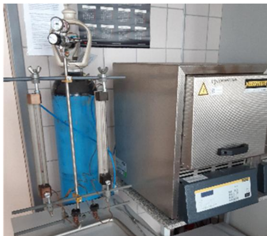
Rys. 2. Piec użyty do syntezy mineralno-węglonych adsorbentów
