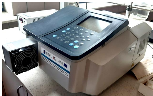
Rys. 4. Widok spektrofotometru UV-VIS Shimadzu UV-1800 wykorzystanego w badaniach własnych
