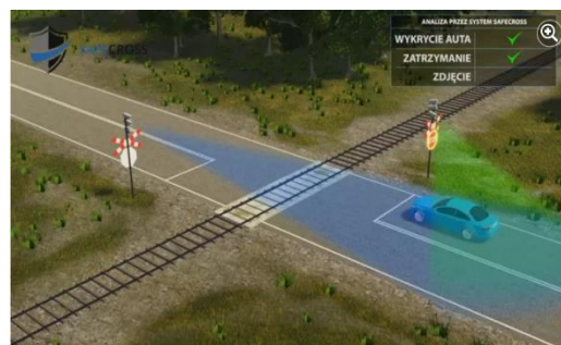
Rys. 7. Idea działania systemu SafeCross [10]
