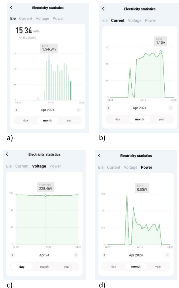
Rys. 11. Obraz z aplikacji mobilnej – wykres a) zużycia energii, b) prądu, c) napięcia, d) mocy [4, opracowanie własne]
