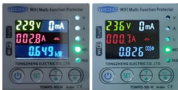
Rys. 3. Panel frontowy MFP – wyświetlana wartość a) mocy, b) współczynnika mocy \cos\phi [4, opracowanie własne]
