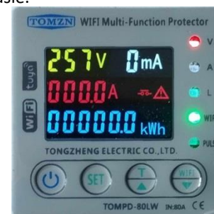
Rys. 9. Panel frontowy MFP – wzrost wartości napięcia [4, opracowanie własne]
