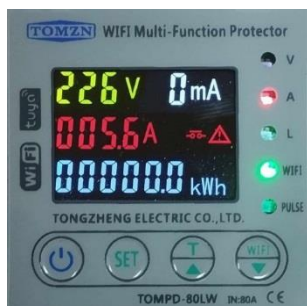
Rys. 7. Panel frontowy MFP – przekroczona wartość prądu [4, opracowanie własne]
