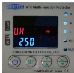
Rys. 5. Programowanie MFP – wartość maksymalna napięcia [4, opracowanie własne]
