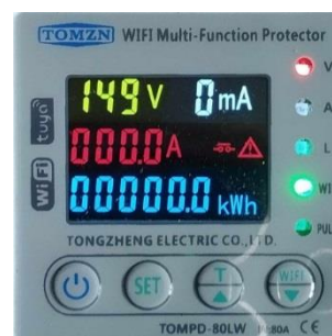
Rys. 10. Panel frontowy MFP – spadek wartości napięcia [4, opracowanie własne]
