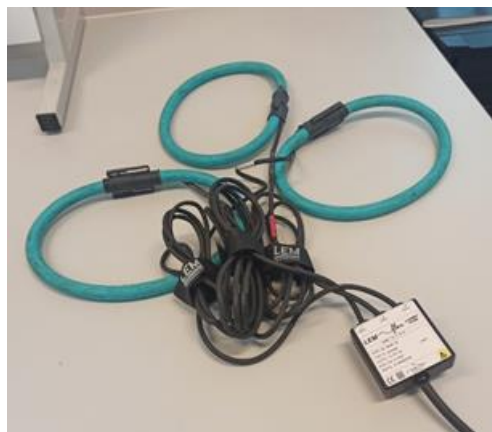
Rys. 2. Elastyczne cęgi prądowe Lem Flex wykorzystane do pomiaru prądów
